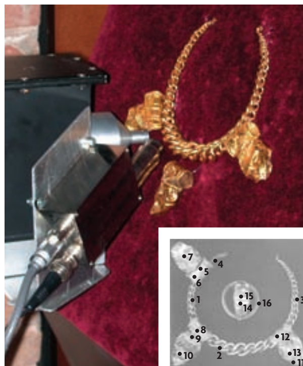
Componentes del Tesoro de Cheste con indicación de los puntos analizados mediante EDXRF.
