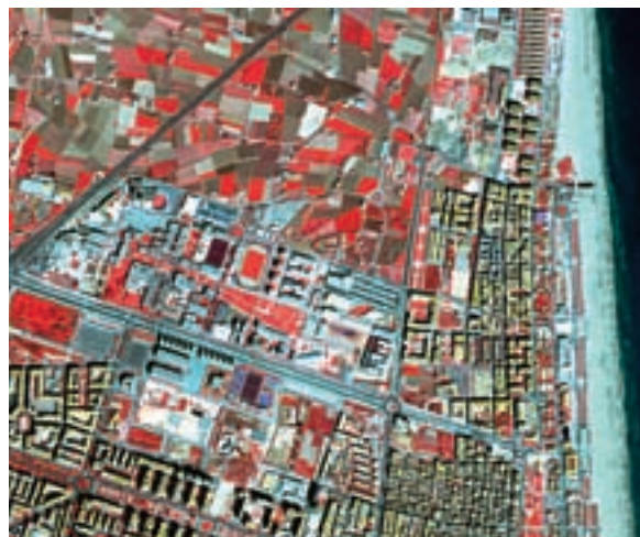
Figura 1. Imatges de satèl·lit. Diferències entre a) una imatge Landsat TM de 2005 i un altra b) QuickBird de 2004 corresponent al nord de la ciutat de València. En ambdós casos es mostra una combinació de bandes en color fals. S'observa la gran diferència de resolució espacial entre les dues imatges.
