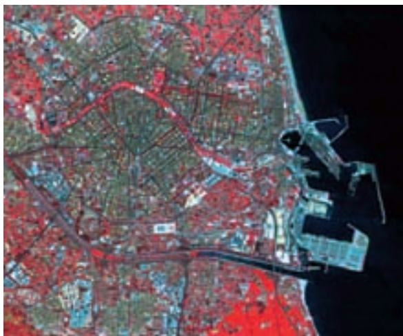
Figura 1. Imatges de satèl·lit. Diferències entre a) una imatge Landsat TM de 2005 i un altra b) QuickBird de 2004 corresponent al nord de la ciutat de València. En ambdós casos es mostra una combinació de bandes en color fals. S'observa la gran diferència de resolució espacial entre les dues imatges.
