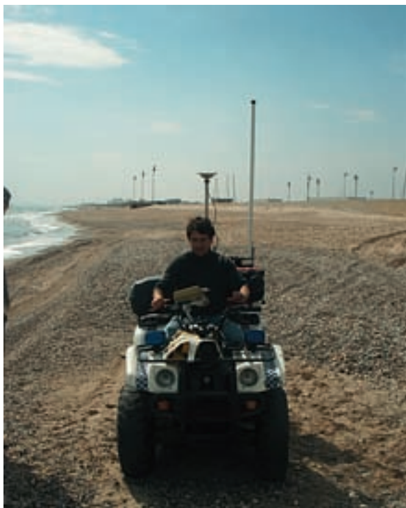
Figura 2. Si col·loquem una antena mòbil d'un GPS-RTK sobre un vehicle de quatre rodes, podem registrar amb gran rapidesa la configuració topogràfica d'una zona. Aquest mètode s'ha mostrat especialment útil per al seguiment dels canvis morfològics en àrees molt canviants i fàcilment accessibles com són les platges.
