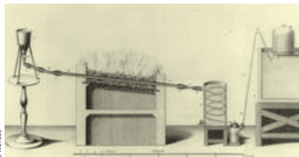
Aparells de Lavoisier per a la descomposició de l'aigua. Aprofundint en el treball experimental de James Watt i Henry Cavendish a Gran Bretanya i de Gaspard Monge a França, Lavoisier va demostrar de manera conclouent que l'aigua no era un element; per fer-ho va descompondre l'aigua en els seus constituents i en acabat els va recompondre en aigua.
