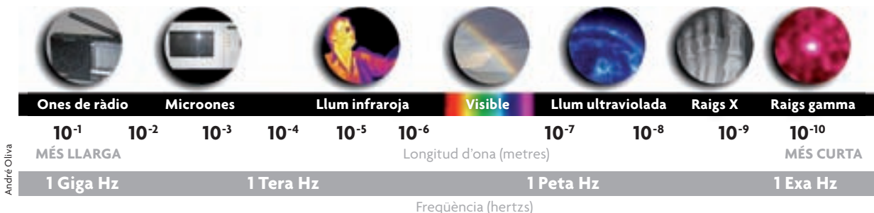
Figura 1. La llum no és més que una ona electromagnètica (una oscil·lació en els camps elèctrics i magnètics que es propaga per l'espai). En la imatge, rangs de freqüències i de longituds d'ona de l'espectre electromagnètic, des de les ones de ràdio, menys energètiques, fins als raigs gamma, més energètics, passant per la regió visible de l'espectre.
